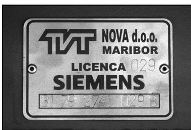
Ein Foto von Hans Nahon verrät zu dem Baulos der Habbiinss-z 2741 für SŽ den Hersteller TVT NOVA/Maribor-SLO und den Konstrukteur SIEMENS-A bzw. die Ursprungsbauart für RCA (ÖBB).
