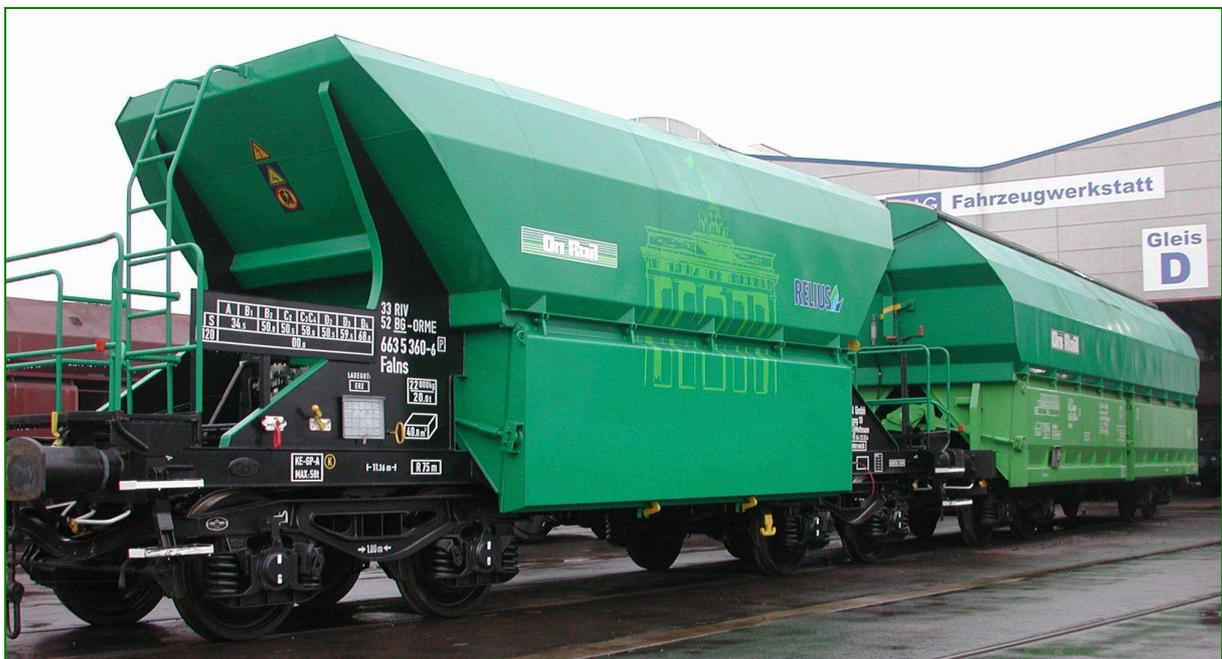
Abbildung 114: 33 52 BG-ORME 6635 360-6 Falns und 33 52 0665 001-2 Talns<sup>29)</sup> On Rail Mettmann o.J.
