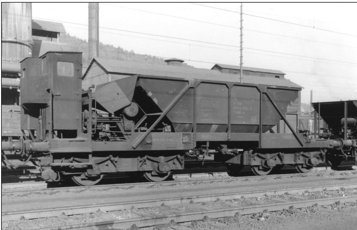
Deutlich sichtbar der Luftbehälter und etwas verdeckt einer der Bremszylinder der Druckluftbremse und unterhalb des Aufstiegs der Dynamo der elektrischen Heizmöglichkeit
